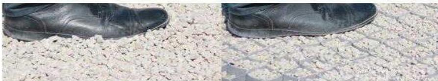
Como vemos en la imagen con la aplicación de la geocelda evitamos el hundimiento, además de evitar el hundimiento el material no se deforma ni se marcan las rodaduras de vehículos gracias a las uniones y al geotextil, confiriéndole una alta resistencia a la tracción.
